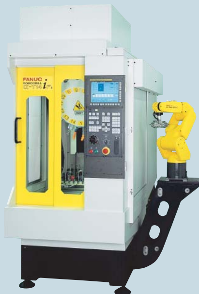
ロボドリルからのロード・アンロード Load/unload from ROBODRILL
