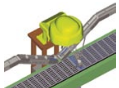
LED照明のレンズ組み立て
