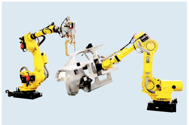
ロボット2台による協調スポット溶接
