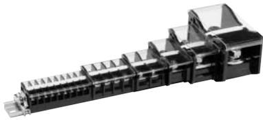
マルチレール式端子台は、UL、CSA、TÜV認証のグローバル対応品です。35mm幅のIECレールをはじめ、4種類のレールが使用できます。必要な容量を、必要な極数で組み立てられますので、経済的な選定ができます。ターミナルユニットのはめ合いが適度な強さになっていますので、必要な極数をはめ合わせて、一度にレールへ取り付けすることができます。なお、小容量フレーム（TX20, TXU20まで）はユニット間への追加取り付けや取り外しが容易に行えます。レールに組み込んだ組立完成品での提供も可能です。詳細についてはC-335ページを参照してください。RoHS指令に対応しています。
