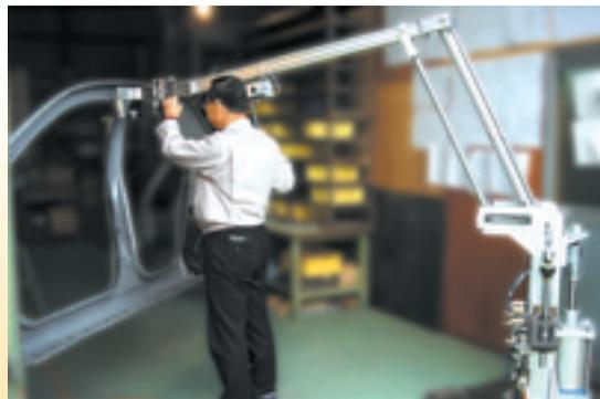
セイフロック搭載で 各軸瞬時に制動、
