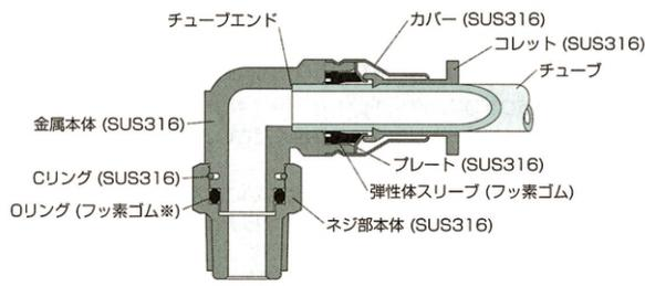
注)メートルネジは、ガスケット(SUS316+FKM)を標準装備しておりますが、管用テーパネジには、シーロック加工を施していませんので配管時にはご注意ください。
