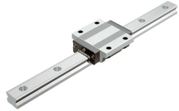
従来のNSR-TBCに比べ高さを低くしているため定格荷重が大幅に増加し、腰の低い安定した直線案内機構が得られると共に下からの取付けが可能となりました。
