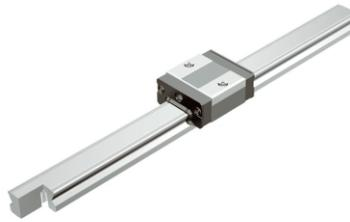
レールの取付面を上面からでなく下面タップ穴にて取付けられます。上面に取付穴がなく粉塵等が入らない構造となっています。
