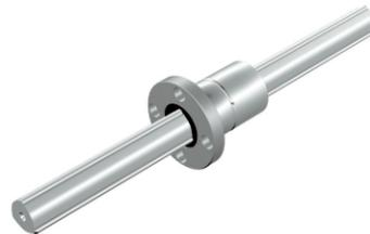
フランジを利用してハウジングにボルトで固定できるので組付が簡単です。ハウジングにキー溝加工すると変形のおそれがある個所やハウジングの幅が狭い個所に最適です。
