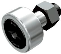
CF形カムフォロアと同じ取付穴に取付けられ、スタッドの取付部とスタッド頭部が0.25mm～1.0mm偏心しているため、スタッドを回すことにより簡単に位置の微調整ができるコンパクトで精度の高い一体構造のカムフォロアです。このため・カム溝との位置合せ、バックラッシュ防止・多数個取付けのレベルあわせ・取付け穴位置の精密加工不要など組付工数を大幅に低減できます。
