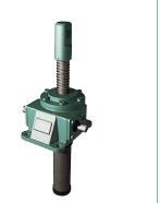
ウォーム歯車と台形ねじ軸を使用した代表的なジャッキです。 低速運転向きで自動締まり(セルフロック)が効きます。
