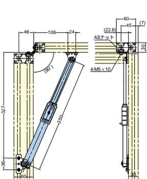
L-FSP350Aステンレス鋼製多段階ストップステー
